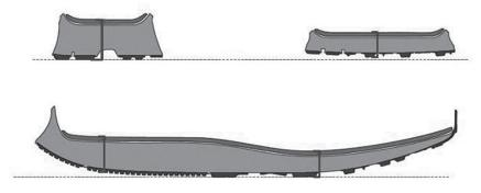
Regola 5 RT a - Misurazione dello spessore della suola
